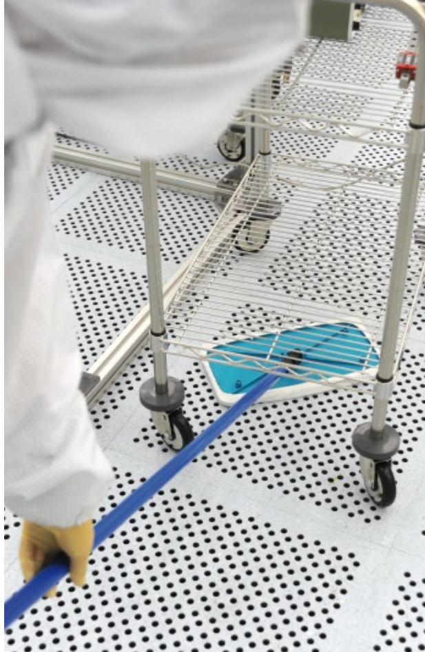
▲ Abb. 2: Das Funktionsprinzip der Sonde Partens von ACP basiert auf einem direkten Messverfahren. Die Kontamination wird hier mit Hilfe der Streiflichttechnologie ermittelt.
