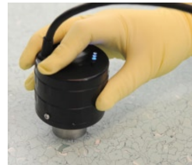
▲ Abb. 2: Das Funktionsprinzip der Sonde Partens von ACP basiert auf einem direkten Messverfahren. Die Kontamination wird hier mit Hilfe der Streiflichttechnologie ermittelt.
